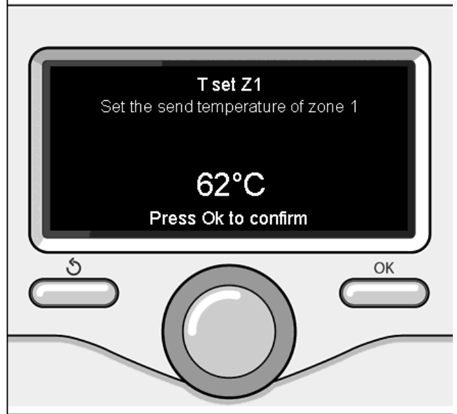
Fűtési meleg víz hőmérsékletének módosítása
